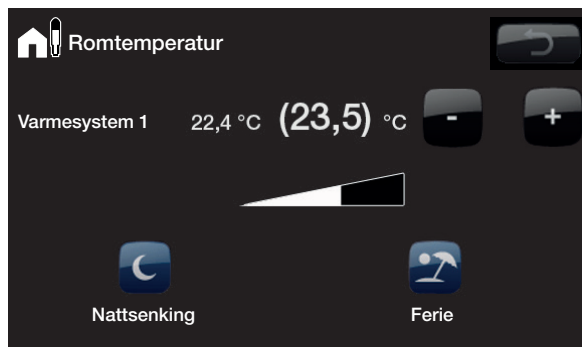
Eksempelet over viser at romtemperaturen er 22,4\text{ }^{\circ}\text{C} , mens ønsket verdi (børverdi) er 23,5\text{ }^{\circ}\text{C} .
