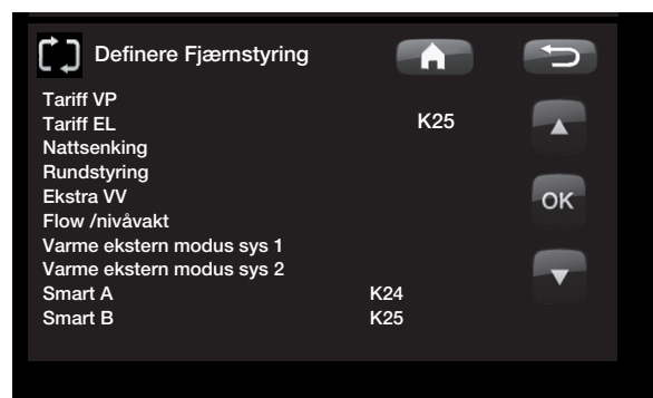
Eksempel hvor Smart A har blitt tildelt lavspenningsinngang K24 og Smart B har blitt tildelt lavspenningsinngang K25
