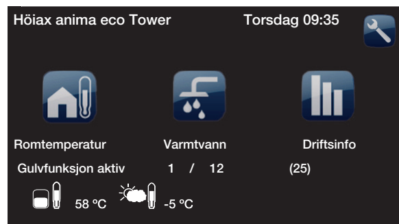
Eksempel for driftsinfo Mode 2, dag 1 av 12 med aktuell børverdi (25) °C.
